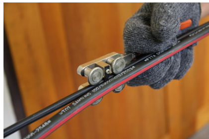
วางล้อลงบนร่อง โดยเข้าทางด้านสายสะพาน แล้วบีบกดใบมีดกลง
